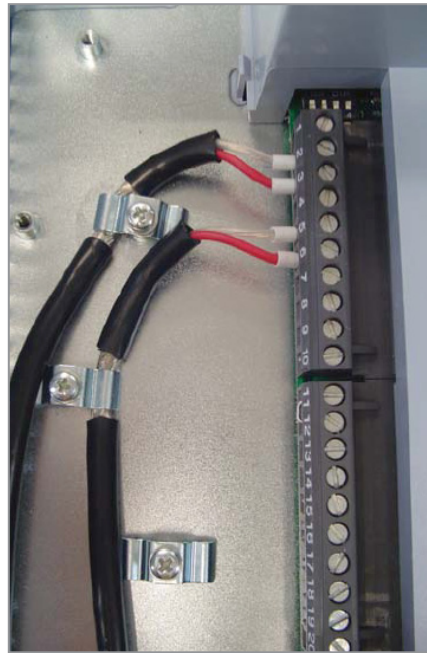
Figura 5.29: Exemplo de conexão da blindagem dos cabos do conector XC1
