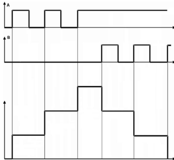
Figura 12.3: Modo de contagem – Pulso A incrementa, Pulso B decrementa. Pulso A e Pulso B (formas de onda superiores) e saída do contador (forma de onda inferior)
