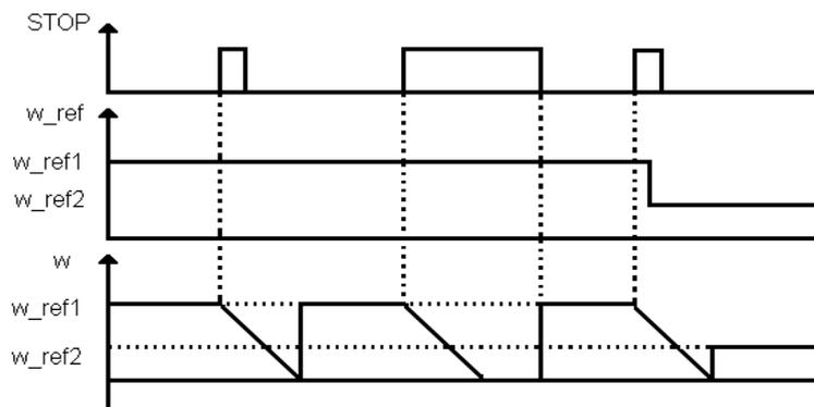
Figura 12.5: Exemplo da função STOP acionada por nível
