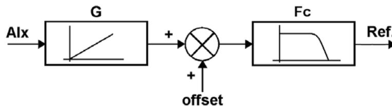
Figura 10.2: Diagrama de blocos das entradas analógicas
