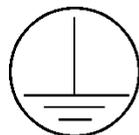
Conexão obrigatória ao terra de proteção (PE).
