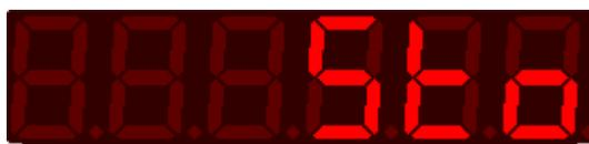
**Figura 4.13:** Tela HMI ao ativar a função de segurança STO
