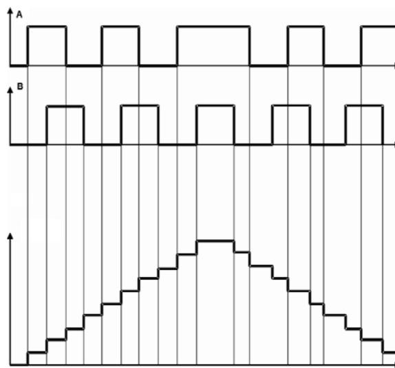
Figura 12.1: Modo de contagem em quadratura. Pulso A e Pulso B (formas de onda superiores) e saída do contador (forma de onda inferior)
