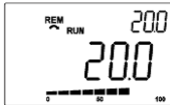
Figura 19.21: Exemplo da HMI no modo monitoração para a função controlador PID2
