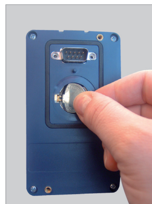
Colocar a nova bateria posicionando-a primeiro no canto esquerdo
