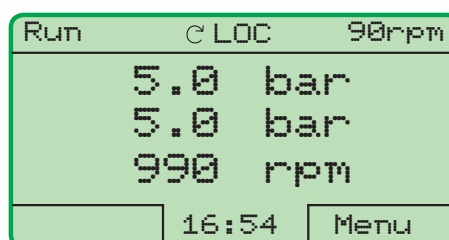
Figura 20.4 - Exemplo da HMI no modo monitoração para a função Regulador PID
